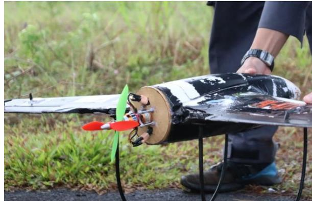
Gambar 10. *Contra rotating propeller* pada UAV *fixed wing*
